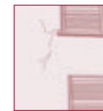
Fessure dovute alla diversa dilatazione degli architravi rispetto alla muratura o dovute ai movimenti dei solai rispetto alla struttura portante
